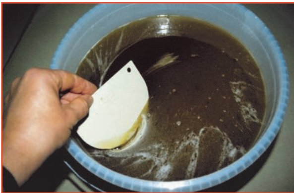
Abb. 21: Wachspartikel werden mit einem Teigschaber zusammengesoben.
