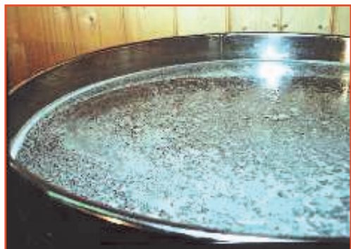
Abb. 20: Schicht mit Wachspartikeln
